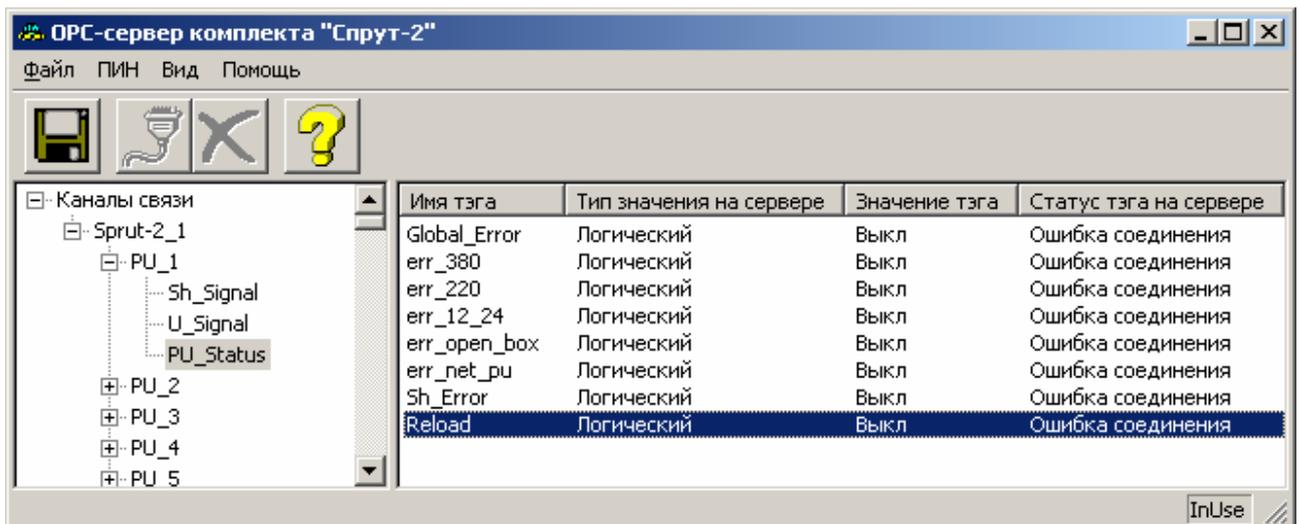
Рисунок 5.4 - Окно конфигурации ОПС-сервера в режиме мониторинга
