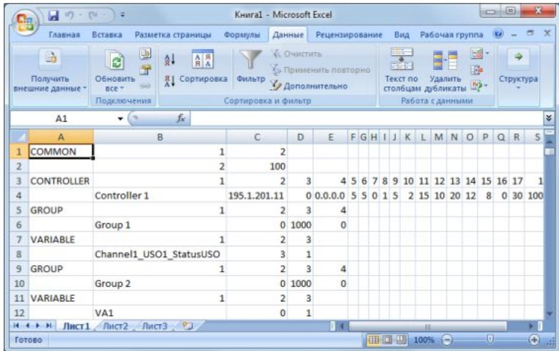
Рисунок 6.11 – Редактирование текстового файла конфигурации в MS Excel
