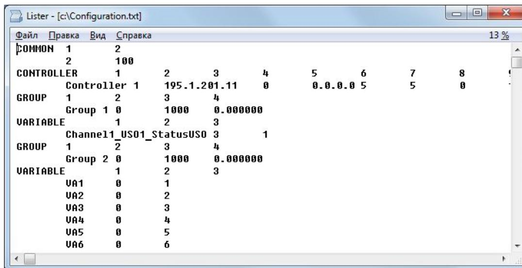
Рисунок 6.10 – Пример текстового файла конфигурации OPC-сервера
